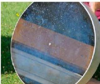
Deutlich sichtbar sind die blinden Stellen auf der Oberfläche des 65-Kilogramm-Spiegels.
